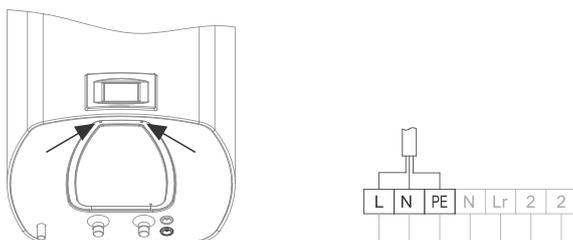
Figure 9a: Installing a power cord
